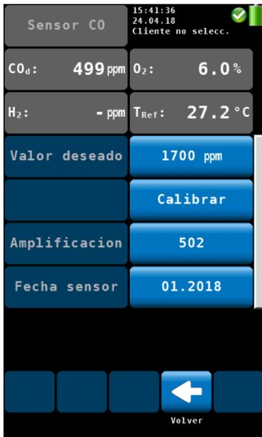
Fig. 51: Introducir los valores de calibración en el menú de calibración (sólo sensor CO)
