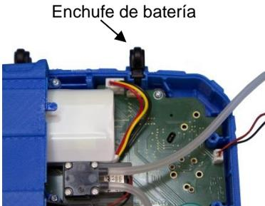
Fig. 52: Batería conectada, los sensores están desmontados, el enchufe del sensor de O<sub>2</sub> y el tubo del canal de gas siguen conectados.
