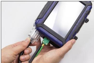
Fig. 38: Extraer la trampa de condensado del analizador
