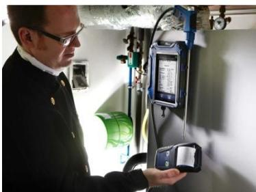
Fig. 20: Imprimiendo datos medidos del Wöhler A 450 en la impresora térmica Wöhler TD 100
