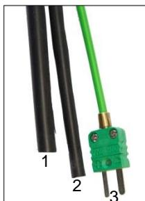
Fig. 13: Manguera de gas (1), Manguera de presión (2), enchufe de temperatura (3)
