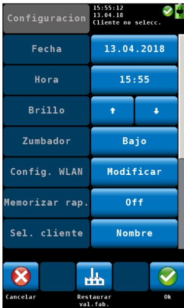
Fig. 29: Menú de configuración, la barra de desplazamiento muestra que hay más parámetros disponibles.
